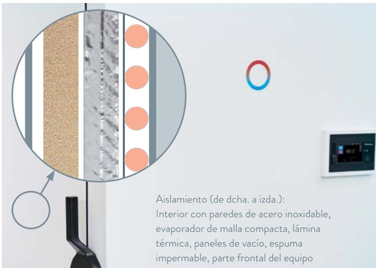
Aislamiento (de dcha. a izda.): Interior con paredes de acero inoxidable, evaporador de malla compacta, lámina térmica, paneles de vacío, espuma impermeable, parte frontal del equipo
